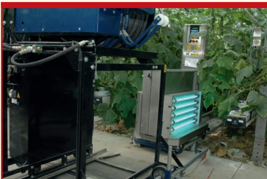
Als een spuitwagen laat de meto-UV-wagen zich op de meto-trans naar de volgende rij rijden.
