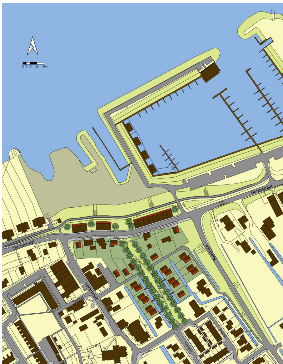
Figuur 8.6 Plantekening van het alternatieve dijk- versterkingsplan Streefkerk.
