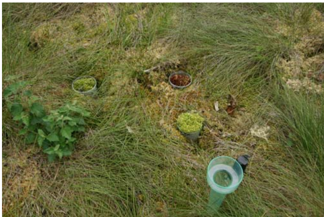
Opstelling om mosverdamping te volgen in het Haaksbergerveen. Te zien zijn de regenvanger (op de voorgrond) en 3 potjes gevuld met S. magellanicum , S. fallax en S. palustre . Het gewicht van de potjes werd wekelijks op dinsdag bepaald tussen juli en september
