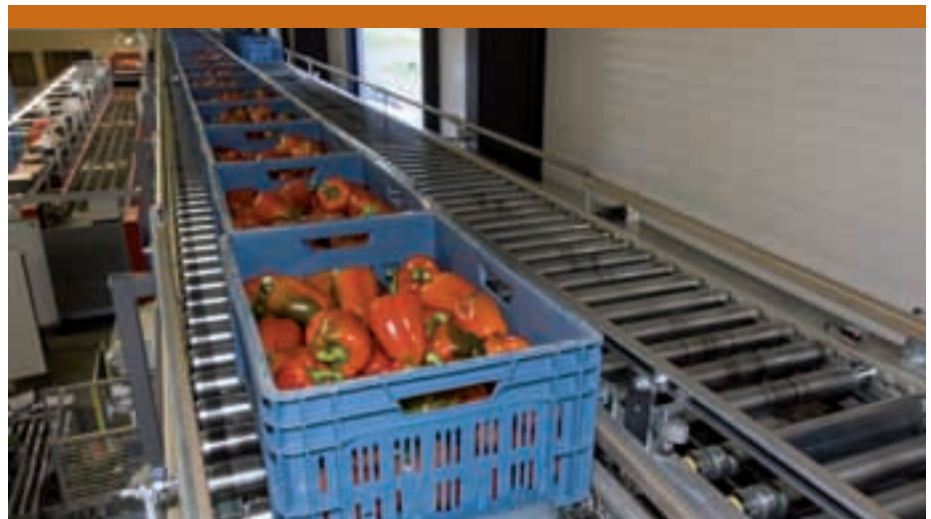
In de buffer lopen de volle kratten paprika's automatisch over de twee rollerbanen.
