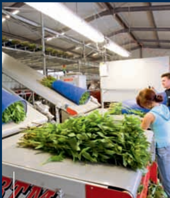
Na het losmaken gaan de stelen één voor één langs drie camera's die het aantal knoppen, de dikte van de steel en de kromming meten.
