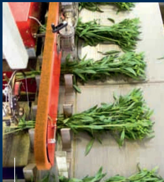
De twee sorteermachines hebben ieder drie uitgangen. De sortering per uitgang is afhankelijk van de te sorteren kwaliteit.
