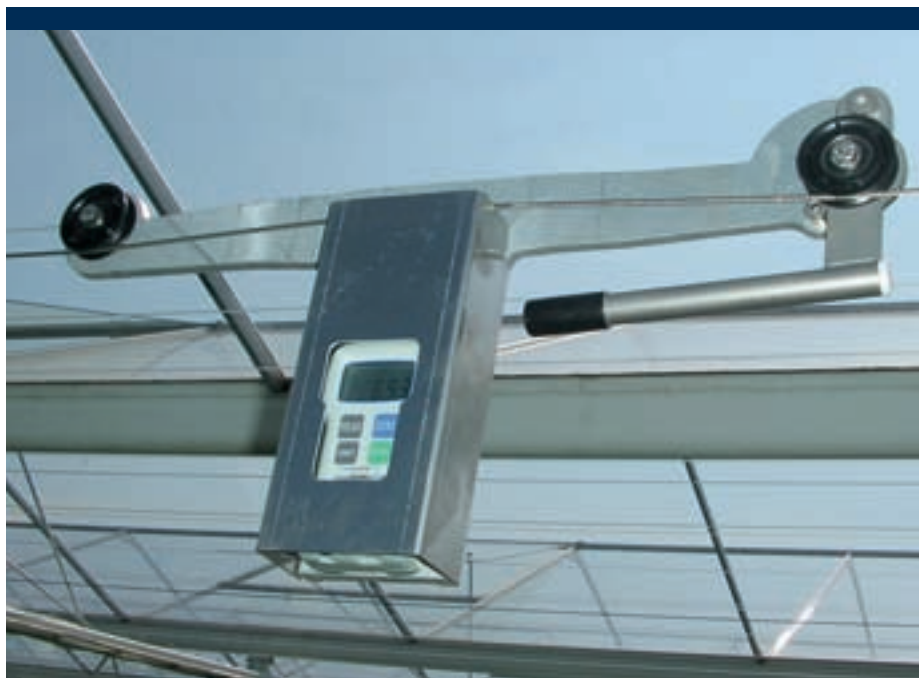
Het meten van de spankracht in een trekdraad.
