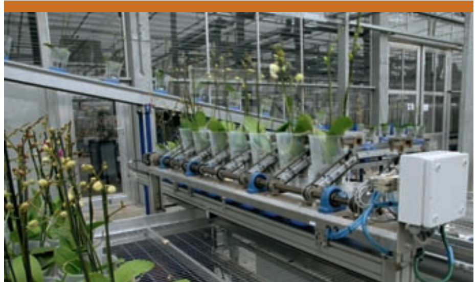
Voor het overzetten is een nieuwe overzetrobot ontwikkeld. Deze bestaat uit twee grijpers die de koker van twee kanten vastklemt zodat geen schade aan de plant ontstaat.
