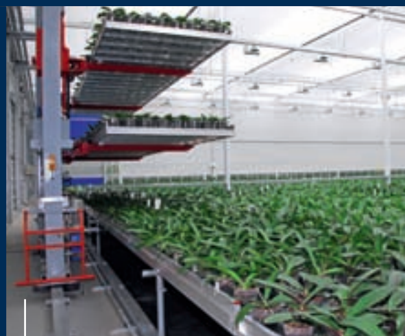
de supersmalle Container Transport Robot brengt 2 tafels tegelijk naar een van de 4 afdelingen...
