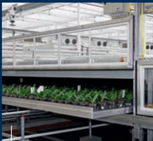
het transport naar de kas gebeurt via speciale transportbanen onder de teeltruimte...
