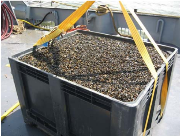
Figuur 2. Weegmethode oogst per m 3 . Een 550 liter kist is tot de rand gevuld met mosselzaad en gewogen met een hangweger.
