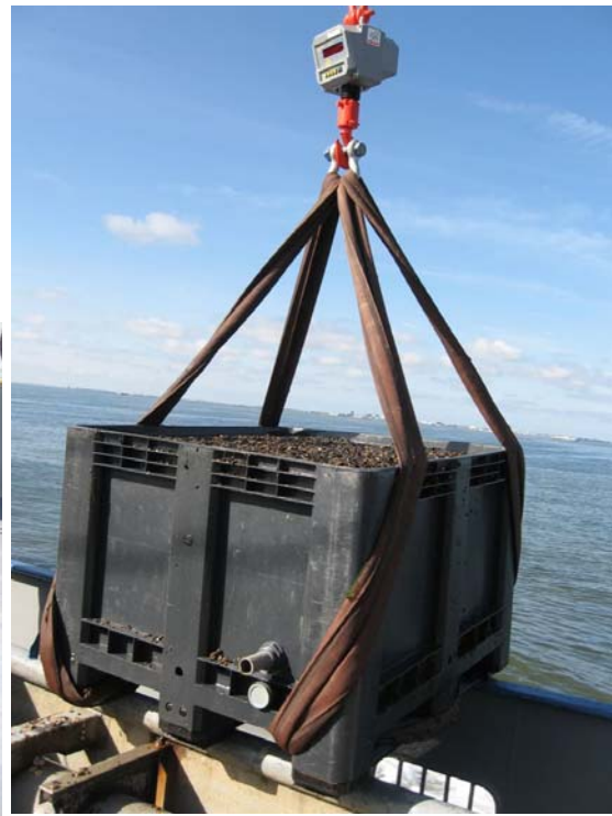
Figuur 2. Weegmethode oogst per m 3 . Een 550 liter kist is tot de rand gevuld met mosselzaad en gewogen met een hangweger.
