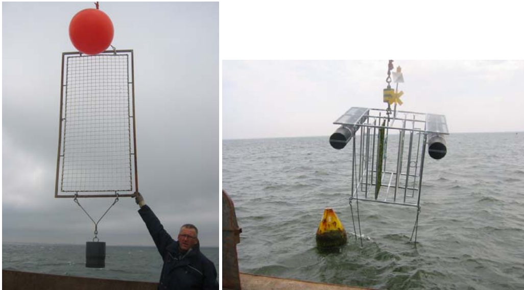
Figuur 3.3. (a) Het enkele rek dat werd geplaatst in week 20 (Waddenzee) of week 22 (Oosterschelde), (b) MONICUBE bij tewaterlating in week 29 (Malzwin, Vuilbaard en Krammer) of 30 (Vlieter en Oostmeep).
