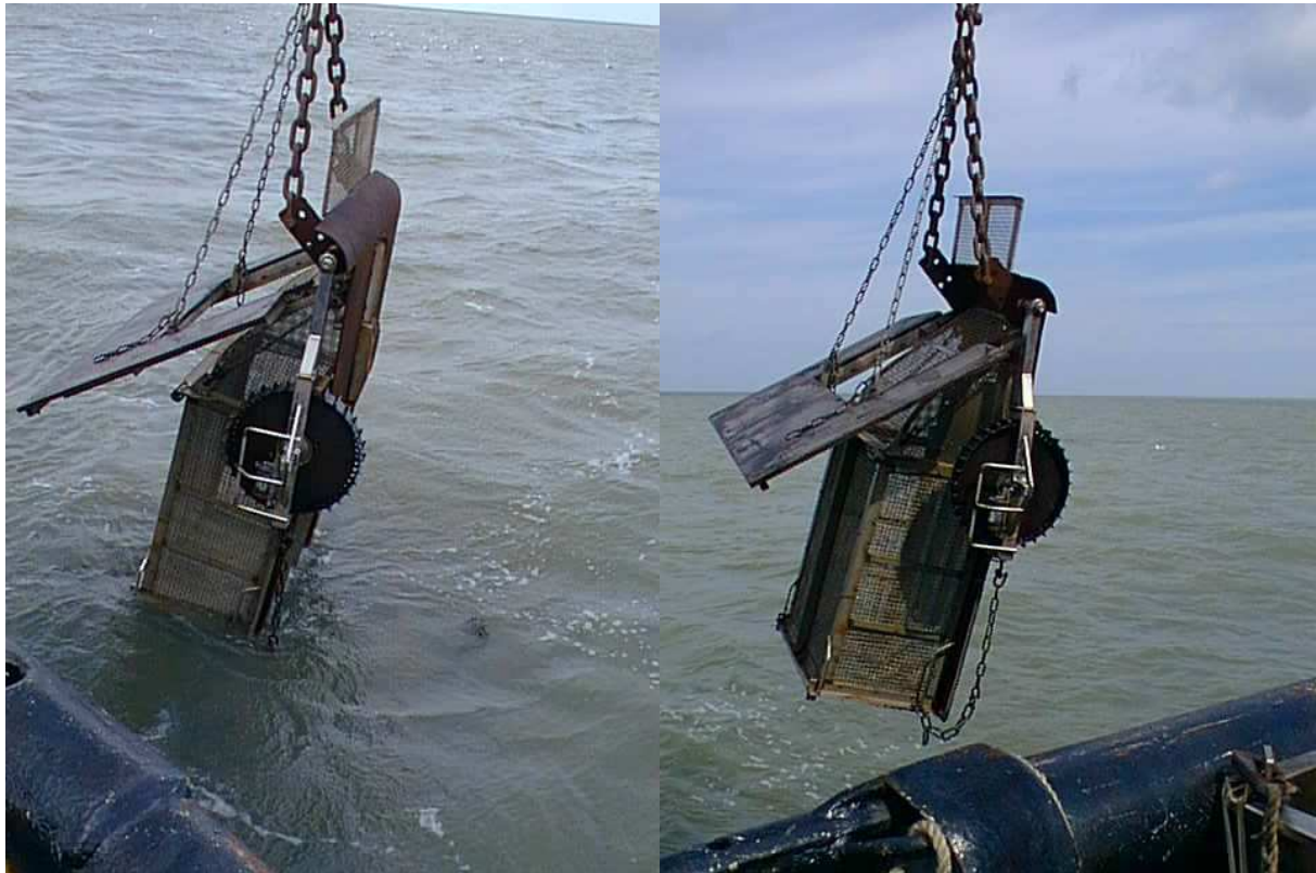
Afbeelding 3.2. De schaaft hangend naast het schip. Met kettingen wordt de spoiler van het frame afgehouden tijdens het vissen. Bij vervoer ligt de spoiler op het frame.
