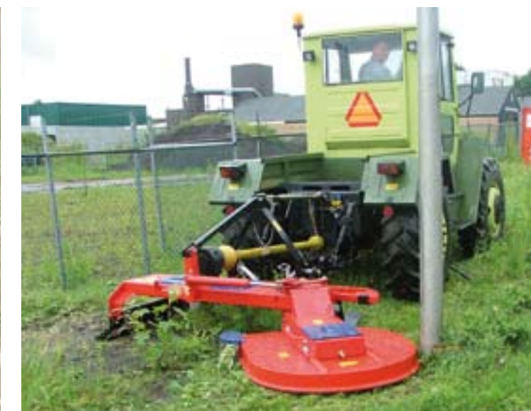
De Beuving maaier is robuust gebouwd en werkt met slinger messen van 1 kilo per stuk. De maaier kan daarom ook vrij ruige begroeiing de baas. De maaierhoogte wordt geregeld met glijsloffen, voor bermenwerk is het beter een loopwiel te monteren. In transport is de maaier handig naar achter te zwenken. De maaier klapt terug op een gasgevulde cilinder.
