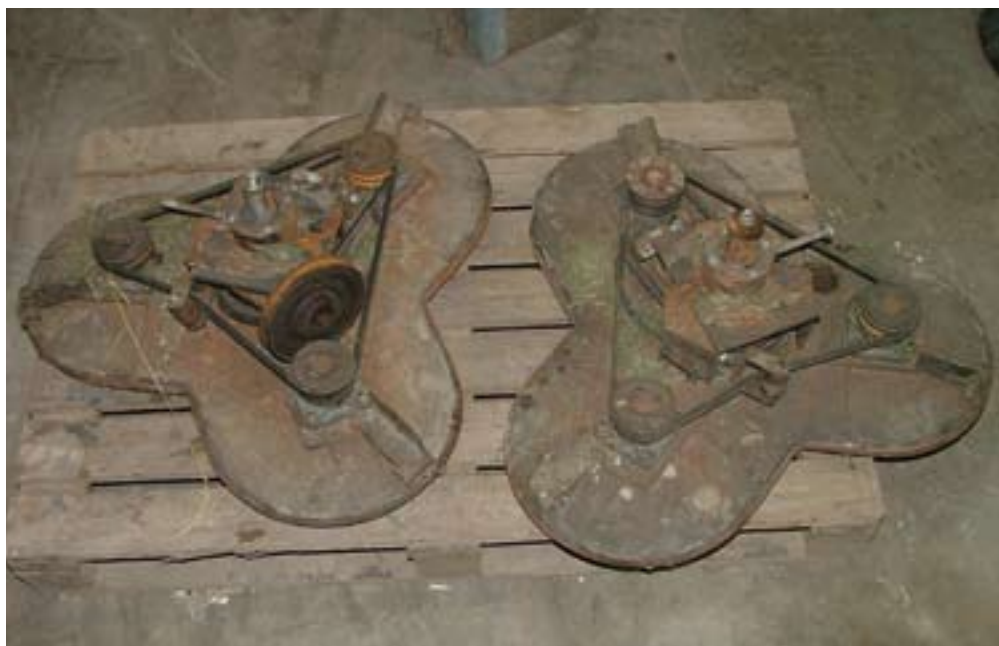
Wat je niet kunt kopen, kun je ook zelf maken. Fruitteler Wil Sturkenboom gebruikt een zelfgemaakte palenmaaier om in de rijen van zijn fruitbomen te maaien. De drie maaikoppen bewegen om de boom heen.
