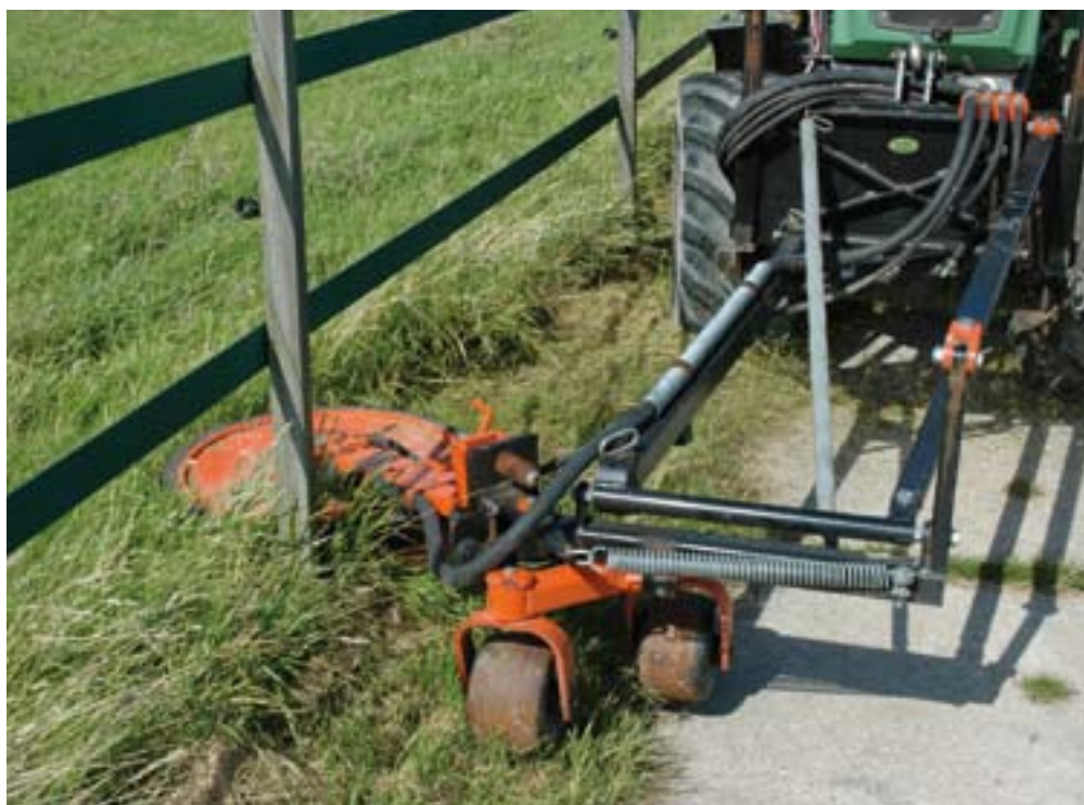
De Solo Swing van Perfect is er zowel voor front- als achter montage en werkt met metalen slinger-messen. De maaier is hydraulisch opzij te verstellen. De maaier wordt met een trekveer om de paal heen geleid.
