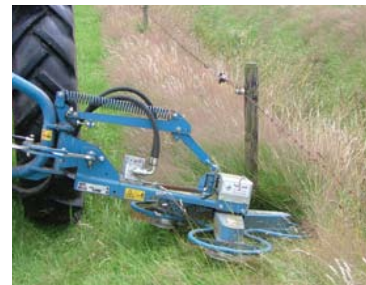
De Zaunkönig werkt met draad aan de maaikoppen. Ook kunststof mesjes zijn mogelijk. Wat dat betreft heeft het principe veel weg van een bosmaaier. Honderd procent rondom maaien lukt alleen met perfecte afstelling en is wat gevoelig. In transportstand wordt de maaier met de hand steil geklapt. Dat is niet zo handig maar hydraulisch opklappen is optie.
