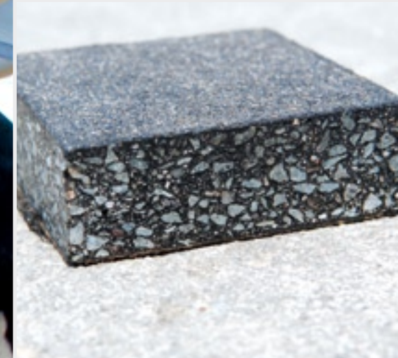
Dwarsdoorsnede van het gietasfalt, met onderop glasvlies.
