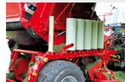
Onder de kappen van de pers is plaats voor 12 rollen wikkelfolie.
