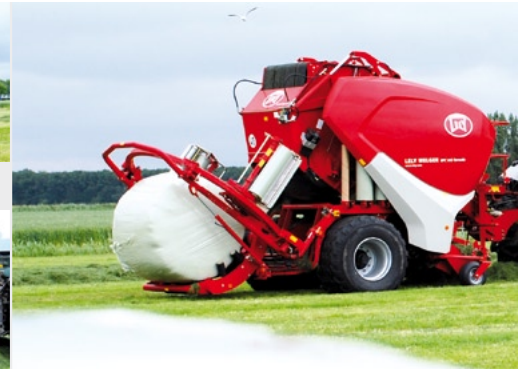
Net voor het afleggen van de baal gaat de ring met de wikkelfolie omhoog zodat de baal er onderdoor kan.
