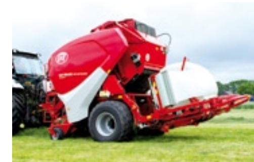
De wikkelfolie loopt altijd door het midden van de baal.
