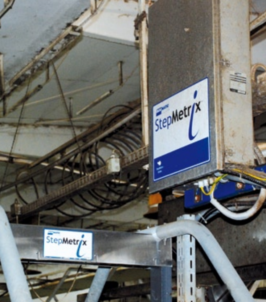
Een kast vol elektronica stuurt de gegevens die Boumatic's Stepmetrix van iedere koe vastlegt draadloos naar de computer in het kantoor van het melkveebedrijf.
