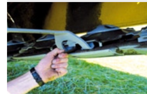
De schijven zijn voorzien van een snelwisselsysteem voor de messen.
