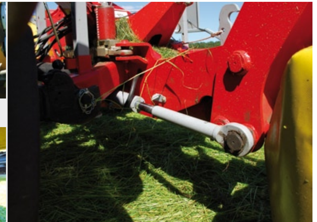
De achtermaaier is voorzien van een uitbreekbeveiliging. De cilinder onderin zorgt voor ontlasting van de maaibalk.
