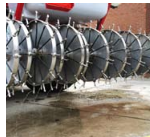
■ Leon van Duijndam reinigt de hoofdleiding en de injectiepiennen. Dit doe je door water in de hoofdleiding te spuiten en de spaakwielen rond te draaien zodat alle gaatjes in de piennen schoon zijn.
