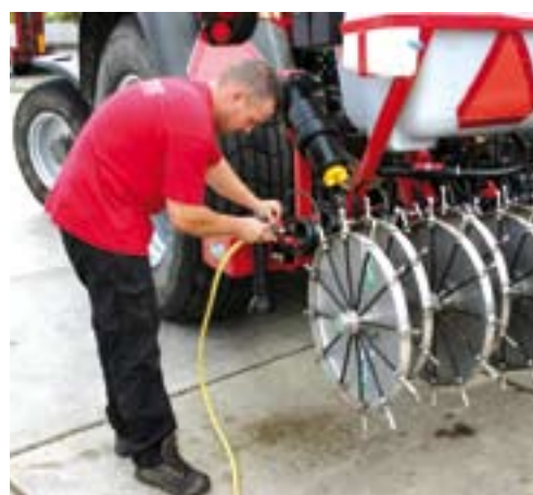
■ Leon van Duijndam reinigt de hoofdleiding en de injectiepiennen. Dit doe je door water in de hoofdleiding te spuiten en de spaakwielen rond te draaien zodat alle gaatjes in de piennen schoon zijn.
