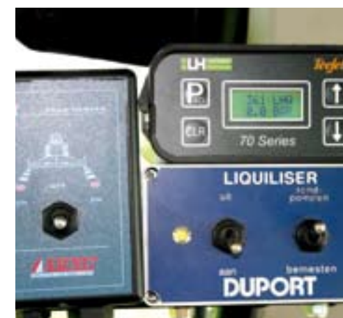
■ De bedieningscomputer is afkomstig van Teejet en eenvoudig in te stellen. Met het kastje van Duport schakel je de bemester aan of uit.
