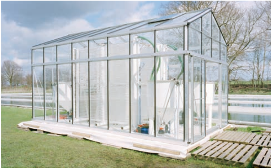
Figuur 4: Bioreactor voor algen in combinatie met open kweekvijver.
