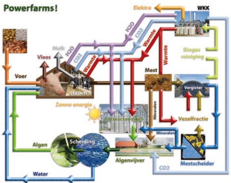
Figuur 1: Schema van de processen in Powerfarms!
