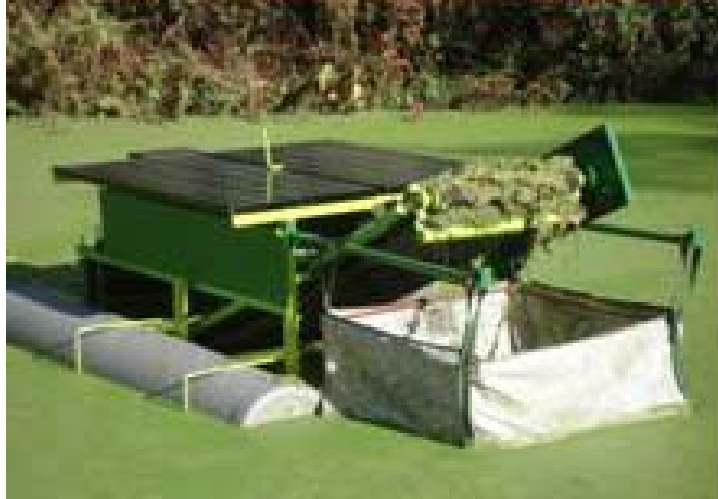
Afbeelding 3 Krooswiel van firma BOM Aqua BV dat draait op zonne-energie
