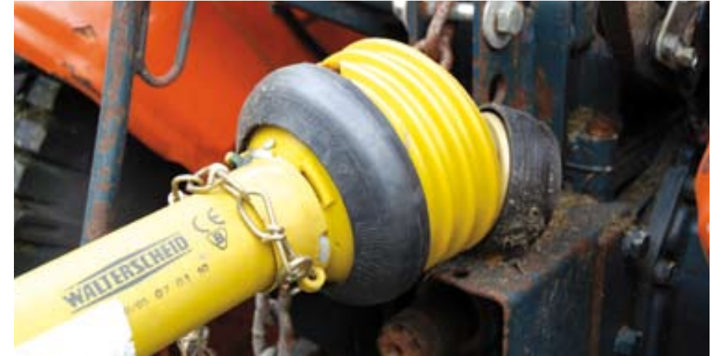
De aftaktussenas van het werktuig is te lang en moet worden vervangen. Om beschadiging van aftaktussenas, trekker- en werktuiglagers te voorkomen, is het van belang dat deze op de juiste lengte wordt gemaakt.
