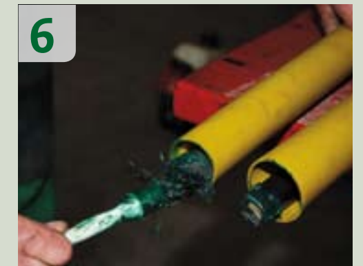
De aftaktussenas van het werktuig is te lang en moet worden vervangen. Om beschadiging van aftaktussenas, trekker- en werktuiglagers te voorkomen, is het van belang dat deze op de juiste lengte wordt gemaakt.
