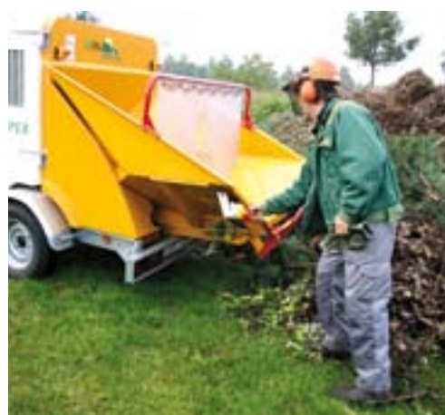
De gele knop dient om de machine vooruit te laten draaien. Bij een eventuele verstopping of vreemd voorwerp kun je de machine achteruit laten draaien met een druk op de rode knop.
