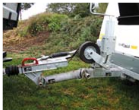
De trekhaak van het onderstel van de alleshakselaar is in hoogte verstelbaar. Handig als er verschillende auto's voor staan.
