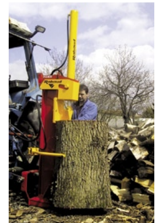
Om dikke stammen te kloven is een aftakas-aangedreven verticale machine in de driepunt van een trekker een uitkomst.
