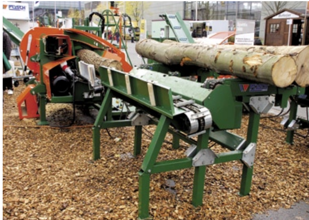
■ Bij deze zaagkloofautomaat liggen de stammen klaar op een tafel. Wanneer de aanvoerband leeg is, rolt er weer een op. Hij zaagt een stam op lengte, klooft het en voert de blokken af.
