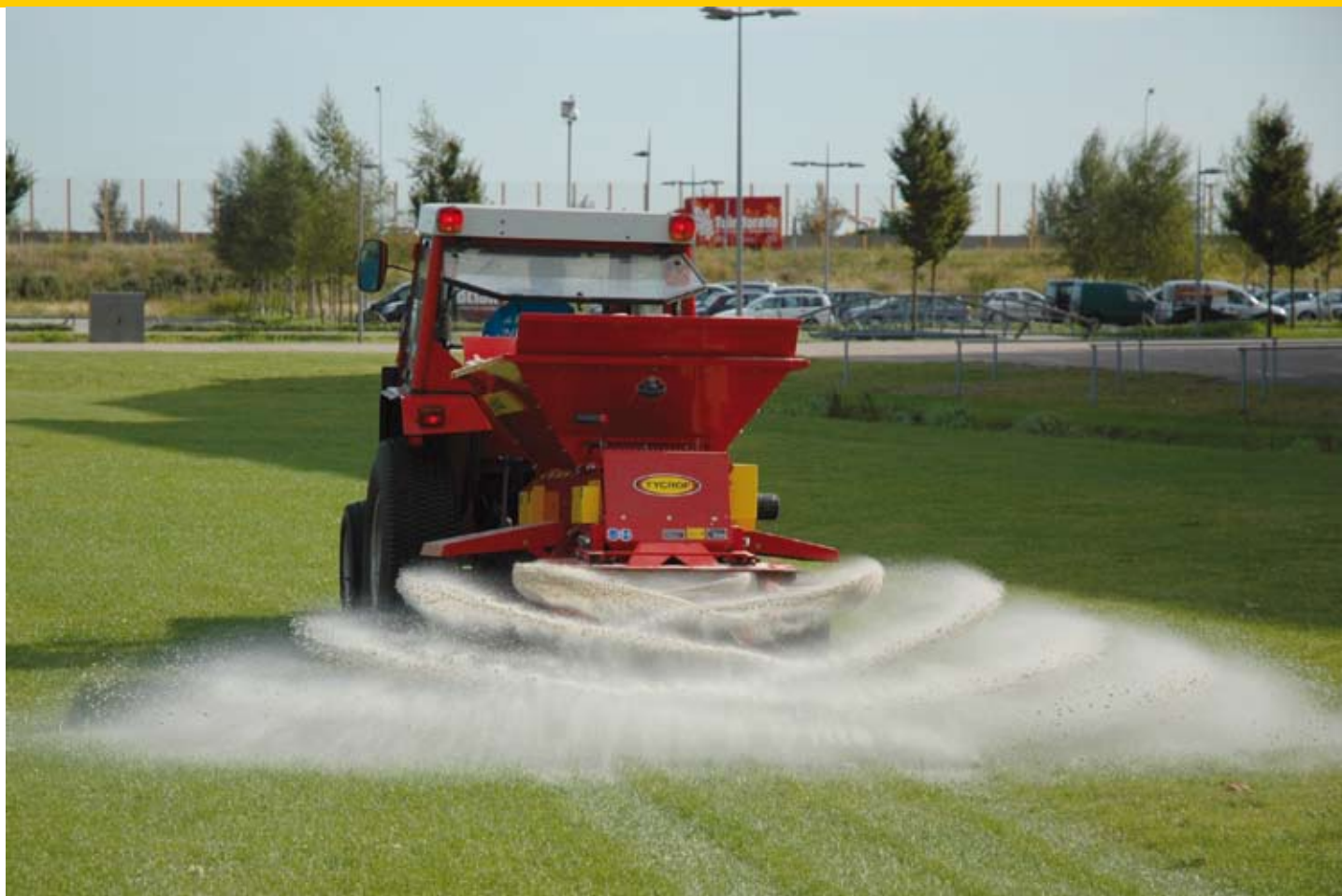
De werkbreedte varieert van 3 meter bij een ultrazware bezanding tot 11 meter bij dustdressing.
