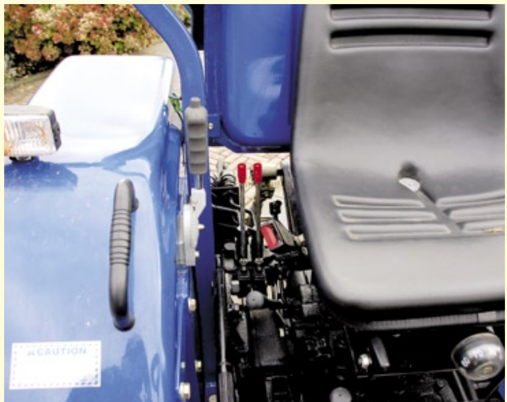
■ De twee rode hendels zijn voor de standaard twee dubbelwerkende ventielen. Links tegen het spatbord is niet de handrem, maar de hendel voor handgas.
