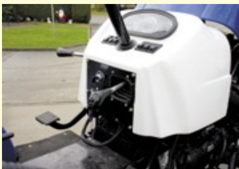
■ Schakelen gaat via poken in de bestuurderkolom. De Hoog/Laag zit rechtsonder de stoel.
