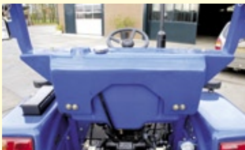
■ De brandstoftank zit nu nog achter aan de rolbeugel. Deze verdwijnt nog onder de optionele cabine.
