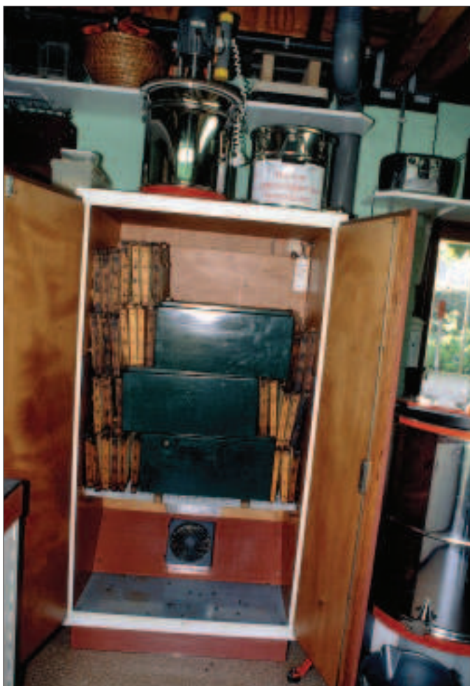
De kast biedt ruimte aan ca 80 tot 120 raten of twee roestvrijstalen vaten van 50 kg inhoud met honingroeders
