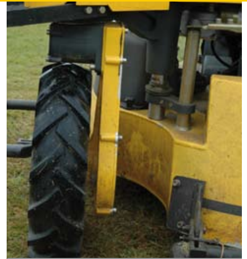
De hydrauliek voor de instelling van de maaihoogte.
