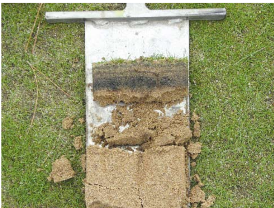
Als je puur anorganisch materiaal toepast als topdressing, loop je het risico dat je een laag creëert die zorgt dat er teveel water op de op de green blijft staan. Deze situatie kan onder meer leiden tot algengroei en grasziekten.
