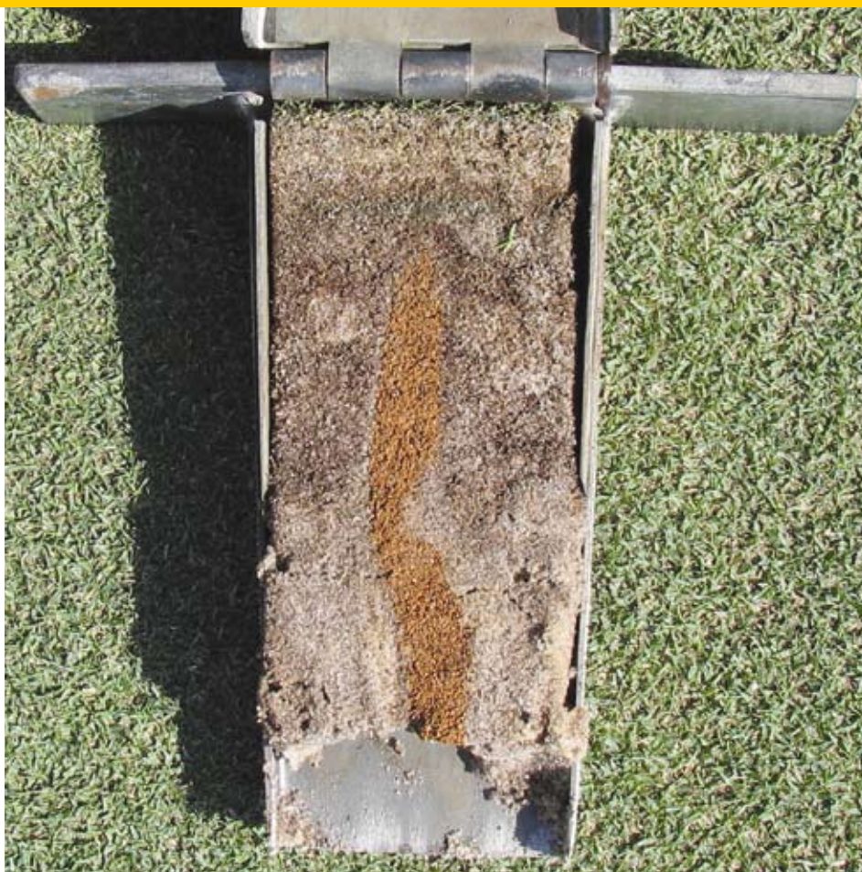
De 'Drill and Fill'- beluchtingstechniek werd in het begin van de jaren 70 ontwikkeld. Hierbij worden gaten gemaakt van 10-11 inch die daarna volledig worden opgevuld met het geselecteerde zand of met een mengsel van zand en anorganisch materiaal.
