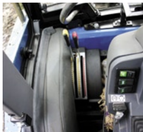
Voor de bediening van de achterhef kun je kiezen uit trek- of positie-regeling.
