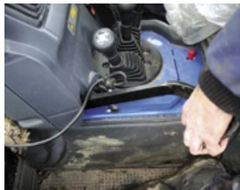
Addie Vennix klappt het koppelpedaal op. Als je dit ook doet met de rempedalen en vervolgens een veiligheidspal losmaakt en de stoel naar voren klappt, kun je het bestuurdersplatform 180 graden draaien.
