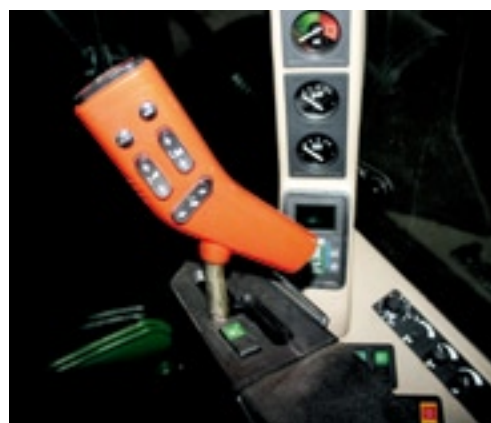
▲ De rijhendel is geïntegreerd in de rechterarmleuning. Hiermee bedien je ook het maaibord.
