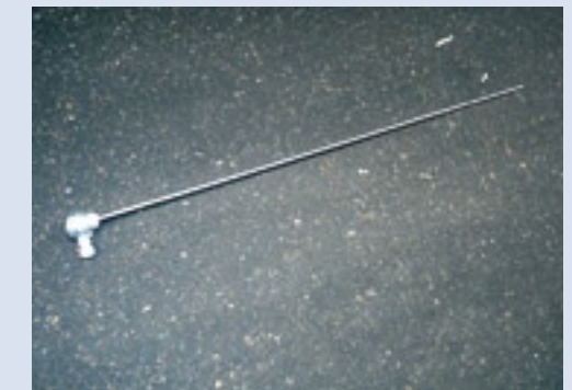
▲ Iets wat u zelf kunt doen, is het controleren van de temperatuurvoelers van de bewaarboxen. Deze kun je rechtop in een emmer met water plaatsen. Vervolgens vergelijk je de gemeten temperatuur door de voelers met de meting door een betrouwbare en nauwkeurige thermometer. Bij een onderlinge afwijking van meer dan een halve graad, dienen de temperatuurvoelers te worden nagekeken.
