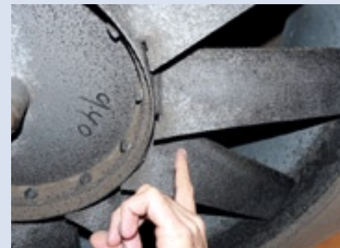
▲ De uiteindelijke luchtverplaatsing wordt gerealiseerd door de ventilatoren. Tijdens het gassen van aardappelen kan aanslag op de ventilatorbladen ontstaan. Deze aanslaglaag kan rendementsverlies opleveren. Door schoepen te verwarmen met een kachel lost de gasaanslag op.
