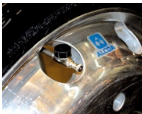
▲ ProEmion levert een druksensor die de bandenspanning radiografisch laat zien op een monitor.
