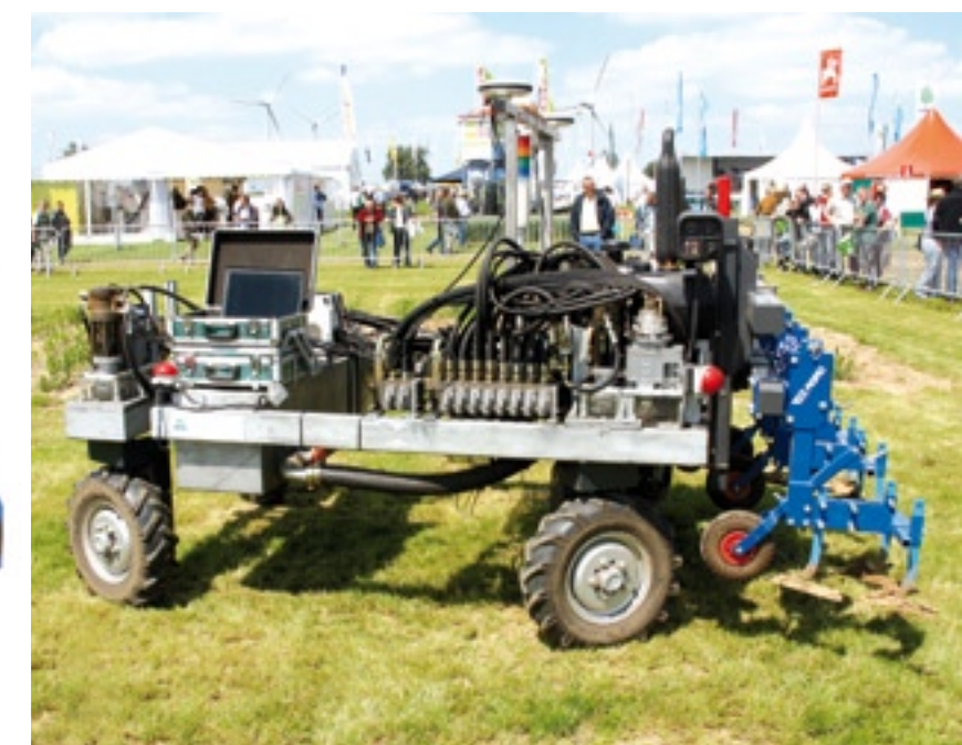
▲ De schoffelmaschine van Wageningen Universiteit heeft vier individueel gestuurde wielen en draait daarmee als een heftruck, bijna op de plaats zelf.
