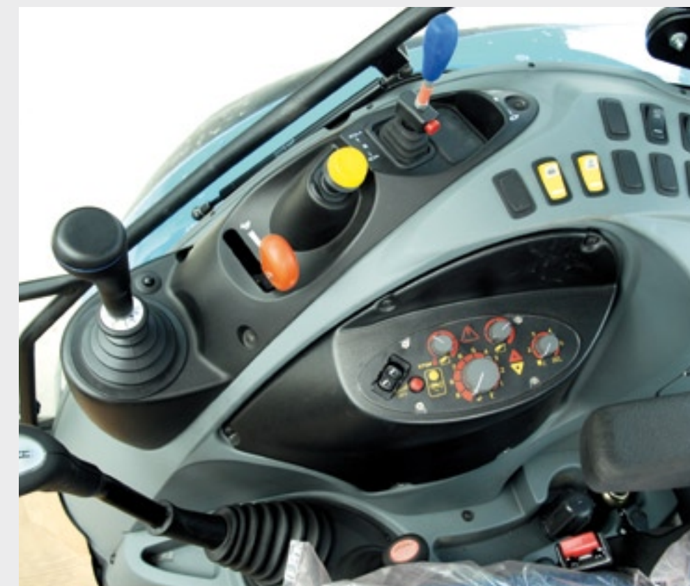
▲ Met de drietraps powershift op de versnellingspook is het, evenals met de belast schakelbare voor-/achteruit, goed werken. Met de stugge groepenpook (midden onder) is dat aanmerkelijk minder het geval.
