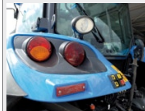
▲ Op het linkerachterspatbord de knoppen voor de buitenbediening van hef en aftakas.
