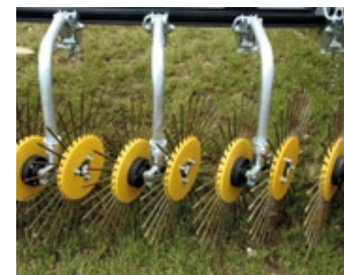
▲ Een bijzondere vorm van onkruidbestrijding (en daarmee gewasbescherming) zijn deze kleine 'acrobaatjes' van Uni-Hacke. Ze komen van het Duitse Annaburger en trekken volgens de fabrikant – mits op het juiste tijdstip gebruikt – tot 80 procent van het onkruid in en direct naast de rijen los. Tegelijkertijd worden de groeiomstandigheden voor de cultuurplanten beter, doordat de grond in en naast de rijen wordt losgekraakt. Doordat de 'sterren' hun aandrijving krijgen van af de grond, is de werking niet afhankelijk van het motortorental van de trekker. Een capaciteit tot 8 hectare per uur is volgens de fabrikant haalbaar. Annaburger uit Annaburg is vooral bekend van grote kiepers en meststrooiers.
