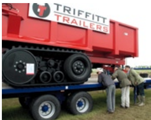
▲ Veel belangstelling (en terecht) voor het nieuwe hydraulisch aangedreven rupsonderstel van Triffitt. De fabrikant uit Full Sutton in Yorkshire mikt daarmee op oogstwerk onder minder gunstige (lees: vochtige) omstandigheden. Die komen in Groot-Brittannië nogal eens voor. Het regent er gemiddeld beduidend meer dan bij ons. In combinatie met het heuvelachtige landschap en de (soms zeer zware) kleigrond loopt de trekker dan met zijn potentie om via twee of vier wielen trekkraft over te brengen al snel tegen zijn grenzen aan. Een deel van het vermogen via olie overbrengen naar een rups die (vanwege de belading) weinig of niet slijpt, kan dan wonderen verrichten. In de getoonde versie kost deze 24-tonniers kieper 42.000 Britse ponden.
