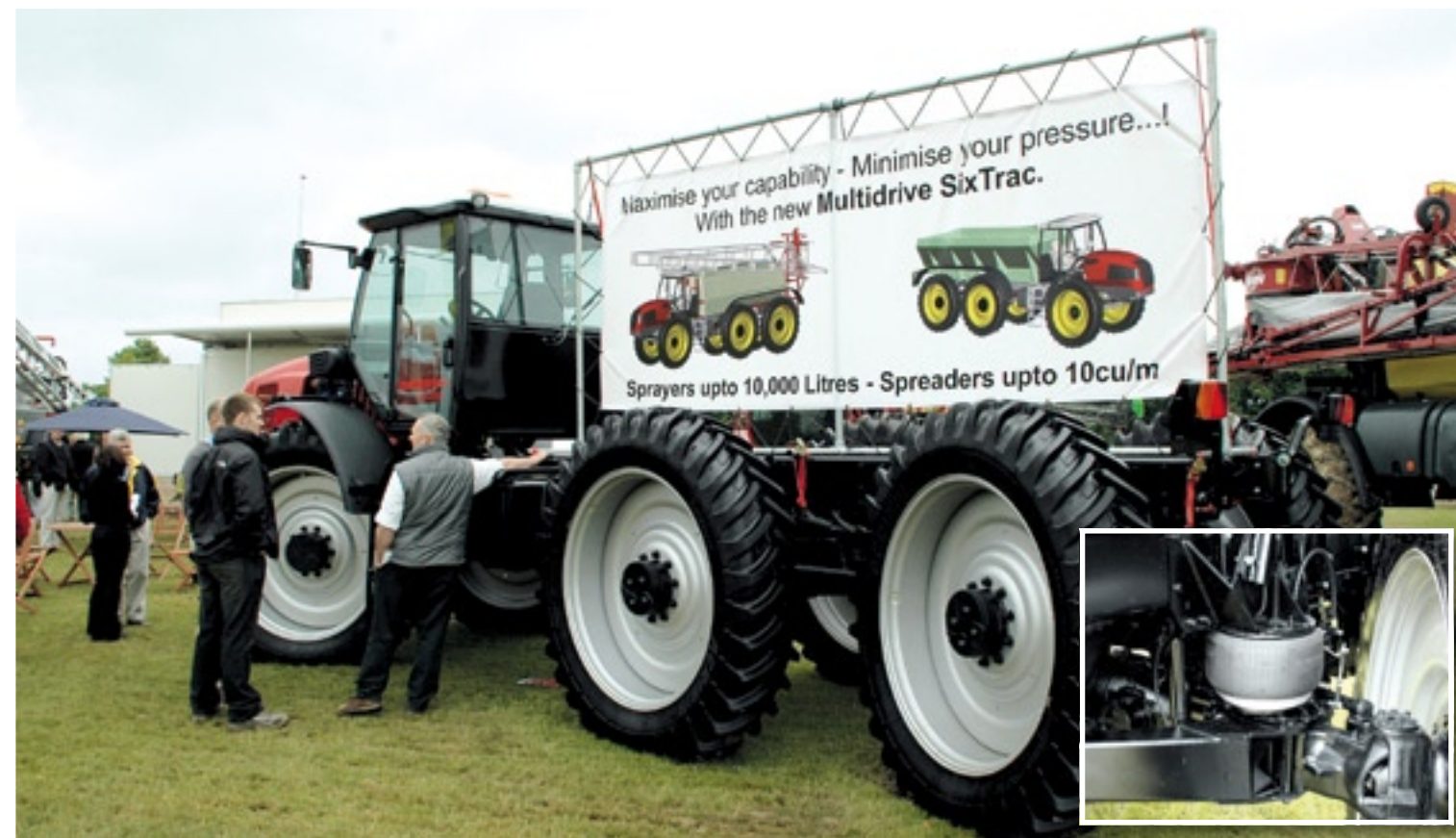
▲ Het grote doek op de drieasser van Multidrive miste zijn uitwerking niet: 'Spuitmachines tot 10.000 liter - Strooiers tot 10 kuub'. Alle drie assen van Spicer op deze nieuwe zelfrijder met de naam SixTrac zijn mechanisch aangedreven, gestuurd en (zie inzet) luchtgeveerd. De gemonteerde Michelin Agribib banden hebben alle zes de maat 380/90R46. De motor is een zescilinder van John Deere en de motorkap scharniert niet bij het openen, maar schuift over een railsysteem in zijn geheel naar voren.
