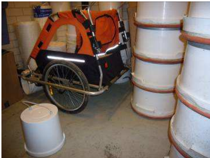
Afbeelding 1. De gasmetingen zijn uitgevoerd via 10 of 67 l. emmers, die eerst 30 minuten afgesloten op het veld. De mobiele meetapparatuur is over het veld vervoerd met een handzame kinderkar.
