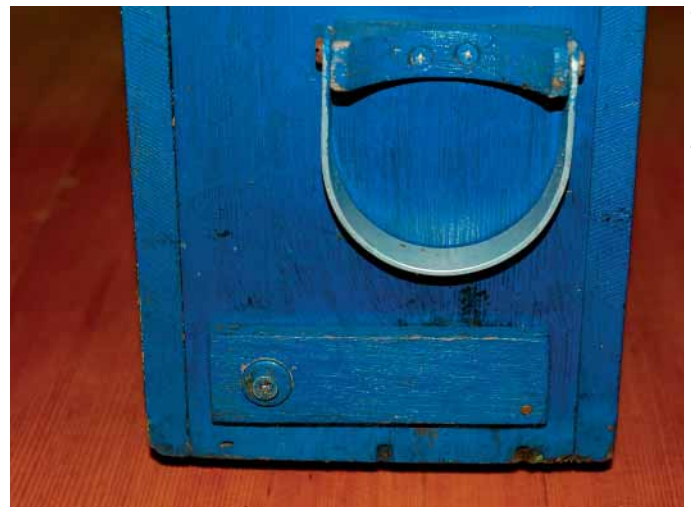
Foto 2. Een beugel om het reservoir vast te houden.
