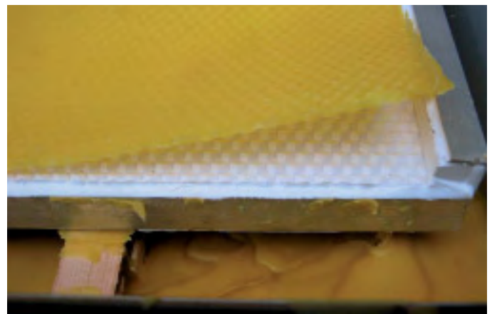
Eenvoudige maar solide verankering van de siliconen gietmal.
