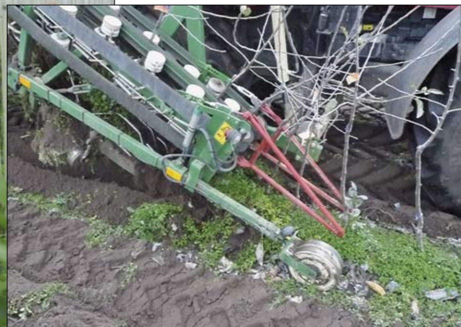
Een klembandrooier schudt alle aanhangende wortels van de planten af.
