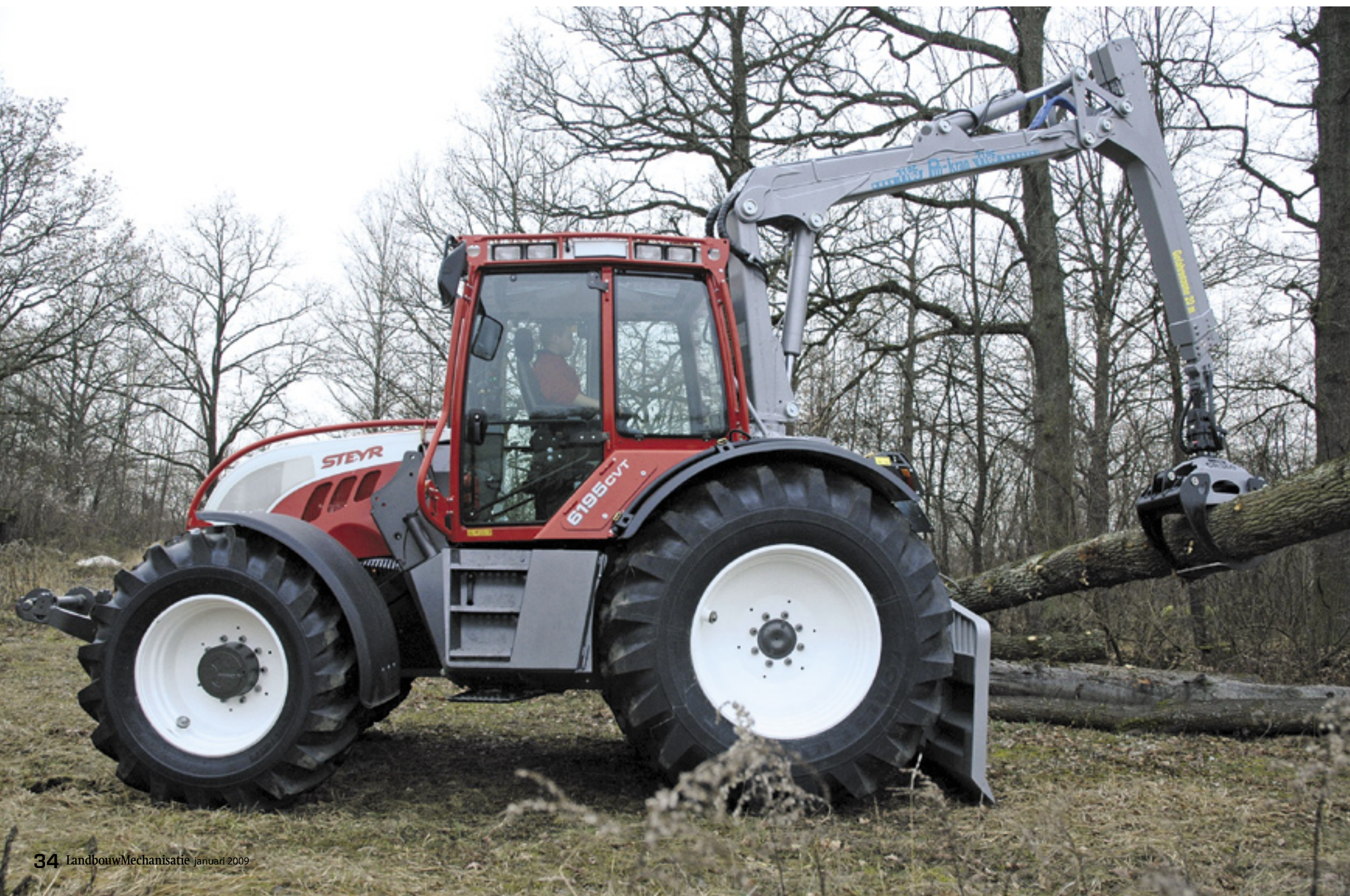
▲ Het wisselen van rijrichting is met de draaibare stoel heel gemakkelijk. Wanneer je de stuurconsole en het stuurwiel wegklapt, gaat de besturing automatisch over op de linker joystick.
