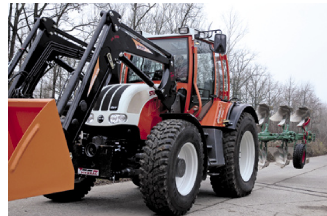
▲ De CVT-Trac is bij bestelling met een frontlader af-fabriek voorzien van een versie van Hydrac. Die wordt bevestigd aan het speciale SAR-versterkingsframe dat bevestigd zit over de volle lengte van de trekker.
