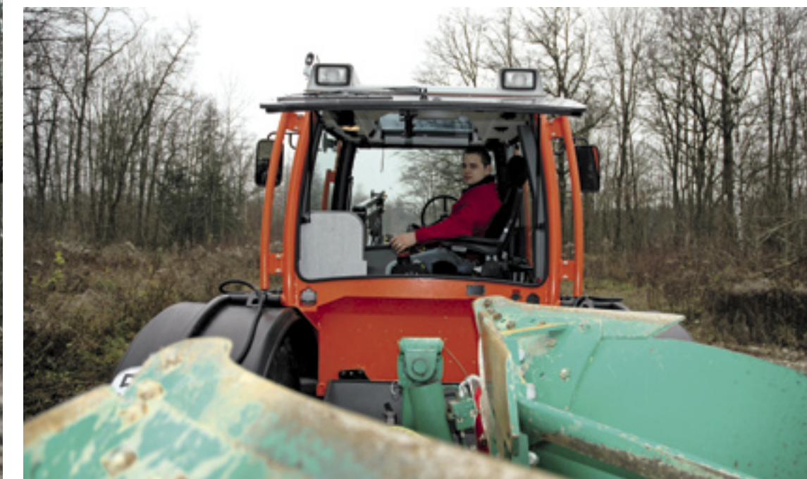
▲ Het wisselen van rijrichting is met de draaibare stoel heel gemakkelijk. Wanneer je de stuurconsole en het stuurwiel wegklapt, gaat de besturing automatisch over op de linker joystick.
