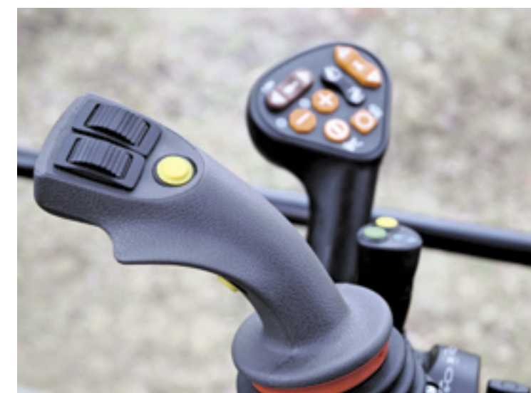
▲ De bediening van de CVT-Trac loopt via joysticks op de linker- en de rechter-armleuning. Voor het normale agrarische werk is er de bekende Steyr-hendel.
