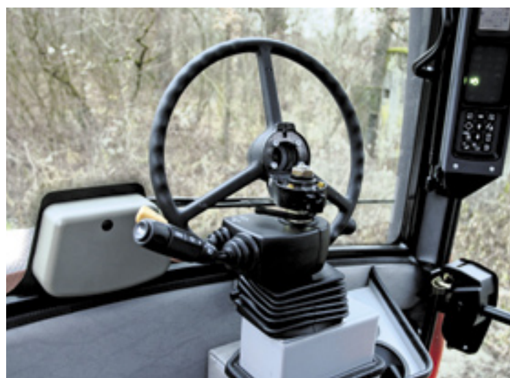
▲ Het stuurwiel en de stuurconsole worden voorafgaand aan het draaien van de stoel naar voren geklapt. Alle andere bedieningselementen draaien mee.
