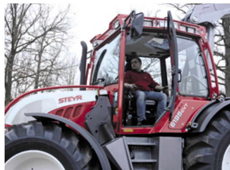
▲ De stoel heeft een horizontaal draaibereik van 220 graden en kan daarbinnen iedere positie aannemen. De chauffeur kan tijdens het draaien blijven zitten.
