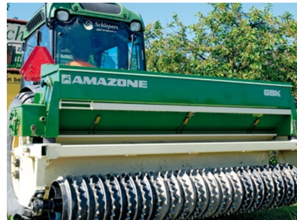
Dit is een combinatie van een rotorkoep en een graszaadzaaimachine.
