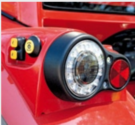
Naast de led-achterlampen zitten knoppen om de aftakas en de hef te bedienen.
