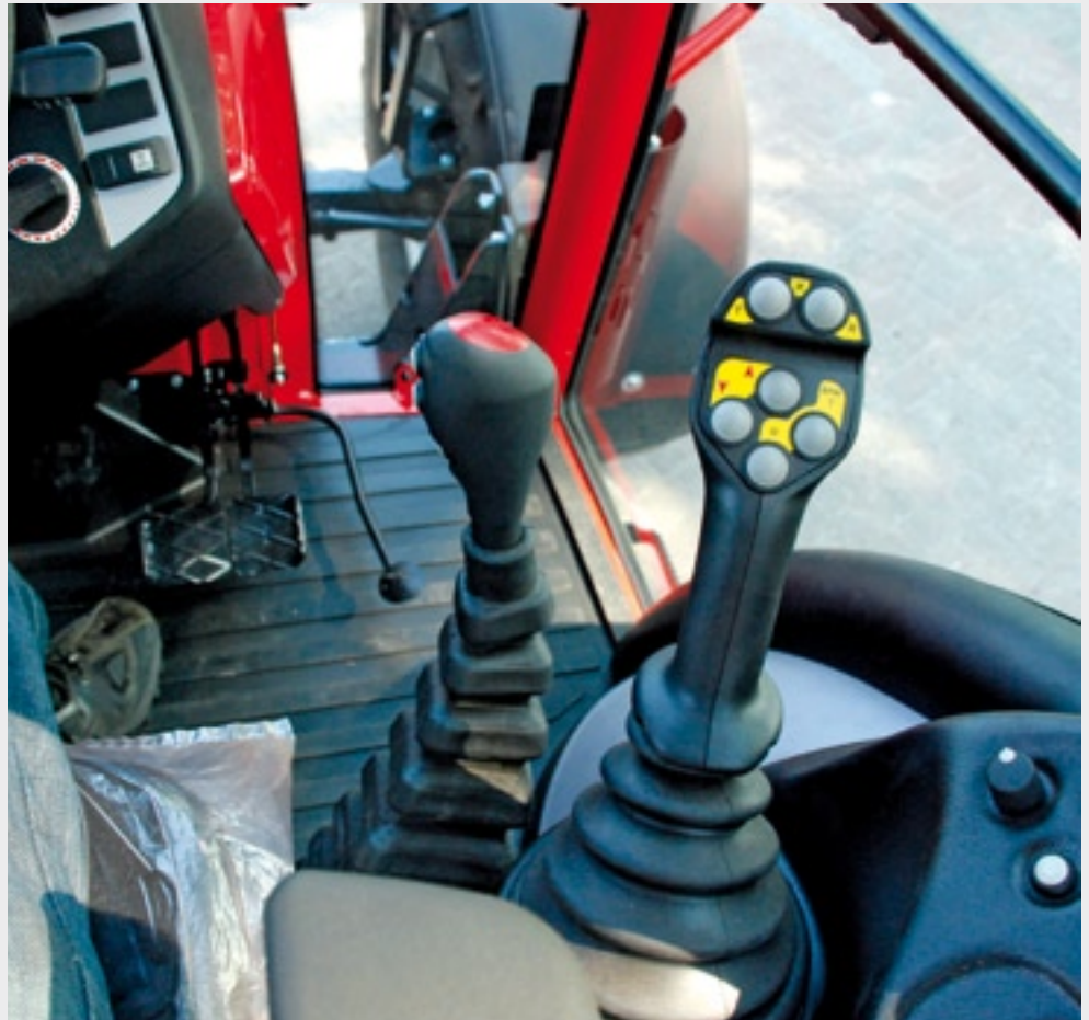
Met de grijze zijknopjes op de rode pook kun je onder last één keer op- en terugschakelen. De gele kruishendel is de optionele multicontroller.
