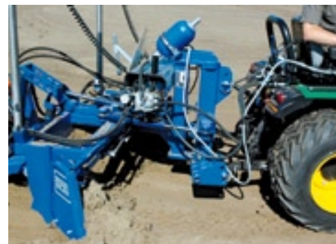
Ook bij driepuntsmontage moet de kilverbak de trekker automatisch volgen. De horizontale cilinders oefenen dan vrijwel geen kracht uit en de kilverbak volgt als een getrokken werktuig.
