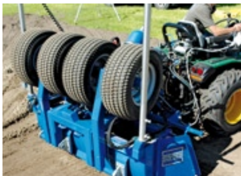
Met een opklapbaar wielstel is het mogelijk om heel strak tegen een muur of omheining te beginnen, waardoor ieder terrein, ook in een gebouw, 'vierkant' kan worden afgewerkt.
