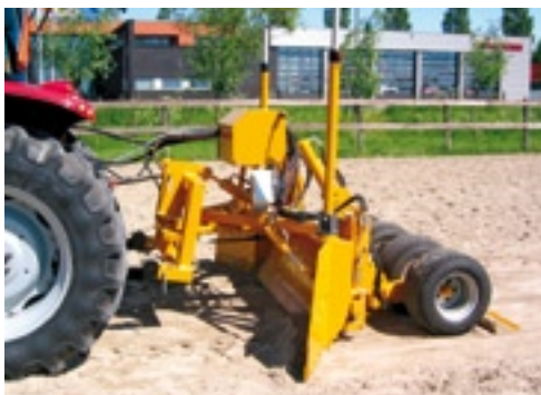
Met hydraulisch verstelbare deuren is de werkbreedte makkelijk tijdens het rijden aan te passen en is het ook makkelijker om randen goed af te werken.
