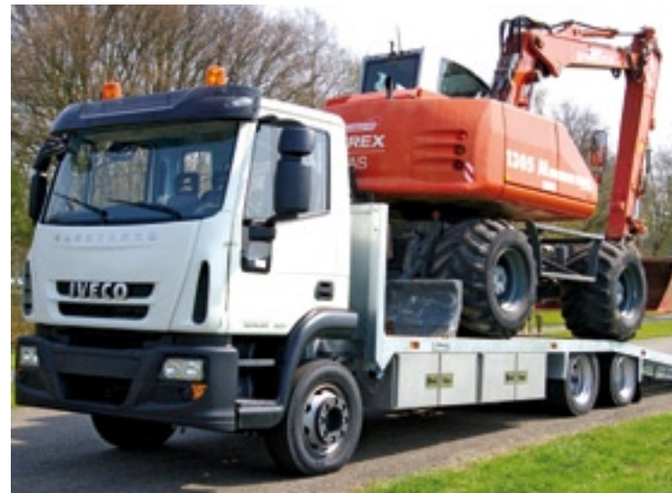
De Iveco Knickargo heeft een laadvermogen van 23 ton en is speciaal ontwikkeld voor het transport van graafmachines en shovels. Met de uitschuifbare laadvloer is de totale lengte maximaal 10,5 meter. De giek steekt dan minder snel achter het voertuig uit. Dankzij luchtvering zijn de achterste assen in een lage positie te zetten, waardoor een kleine oprijhoek ontstaat.
