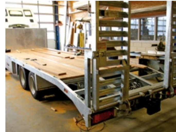
Naast de 23 tons Knickargo werd ook een versie van 16 ton gebouwd. Die is geschikt voor het trekken van een 12 tons aanhangwagen. Als basis werd een Iveco EuroCargo gebruikt.
