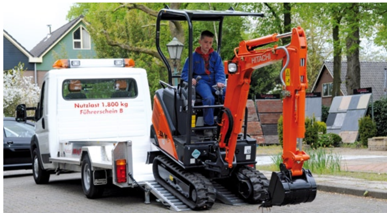
Speciaal voor het vervoer van minigravers en shovels bouwde Veldhuizen een Fiat Ducato dieplader. Door gebruik te maken van een aluminium chassis en laadbak heeft de auto een eigen gewicht van 1.700 kg. Dit levert in totaal 1.800 kg laadvermogen op. De dieplader heeft standaard een bakmaat van 370x173 cm. Optioneel is dat 400x173 cm. Het achterste gedeelte van de laadvloer loopt schuin af voor een lage oprijhoek. De laadbak is voorzien van twee 1,2 meter lange oprijplaten. De 82 kW (120 pk) Fiat is te besturen met rijbewijs B. De Ducato dieplader kost 27.800 euro inclusief trekker.
