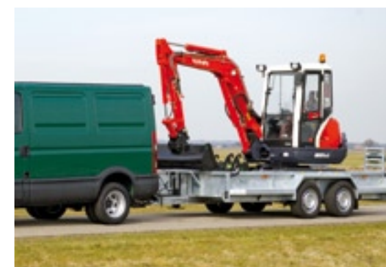
Voor de Iveco Daily 35C15 werd een 6 tons trekhak ontwikkeld met 4.900 kg laadvermogen.
