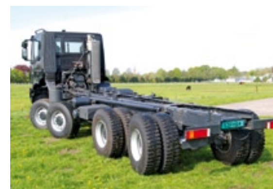
Met het WSG tandemstel heeft de Iveco Trakker vier ton extra laadvermogen gekregen.
