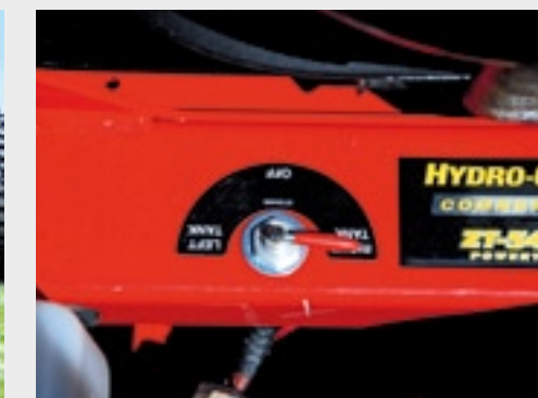
Via een kraantje achter de stoel kun je overschakelen van de linker- naar de rechtertank.
