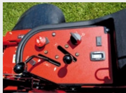
Het bedieningspaneel is eenvoudig met een grote gashendel. Op de urenteller staat 0,4 uur.
