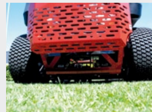
Onder het subframe achterop loopt de aandrijving via een dubbele snaar naar voren naar het maaidek.
