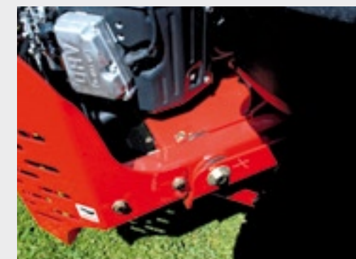
De motor en transmissie met hydropomp zitten achterop in een apart subframe met rubbers.
