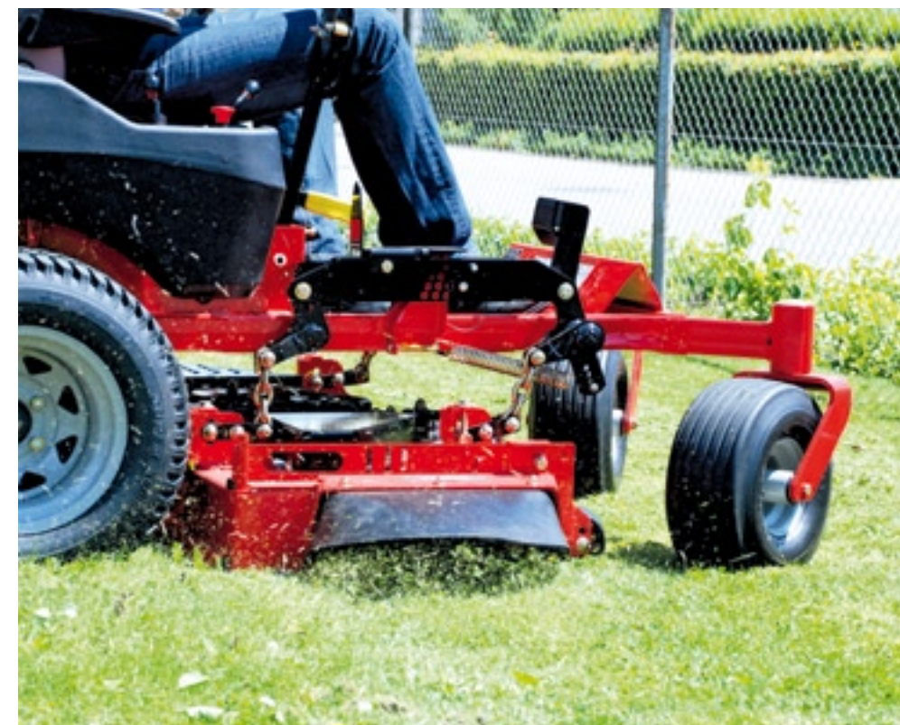
Het maaidek hangt in kettingen onder het frame. Voorop zitten twee forse zwenkwielen.
