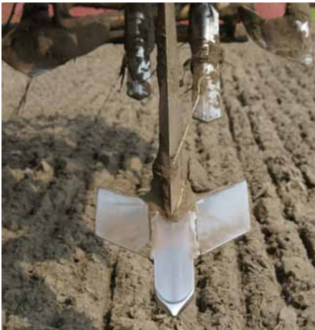
◀ Achter de diepe woelertand komen twee tanden, die de mest ongeveer elf centimeter diep weg leggen.
