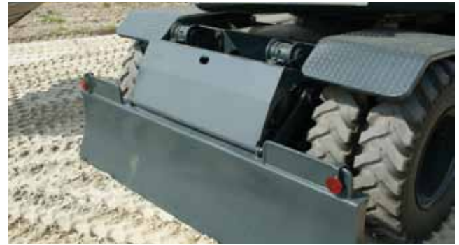
Zo zien we het graag bij de dozerbladophanging: degelijk en goed afgeschermd. En spatborden die tegen een stootje kunnen.
