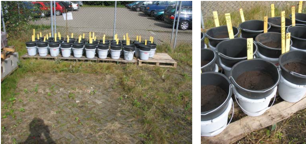
Figuur 3. Experimentele opstelling bij Alterra (links) en gevulde lysimeters (rechts).
