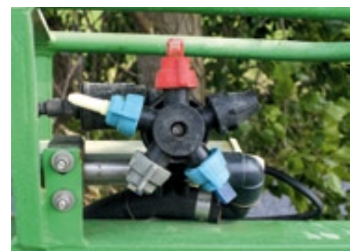
▲ Optie: pneumatisch afsluitbare doppen. Die hebben een korte reactietijd.
