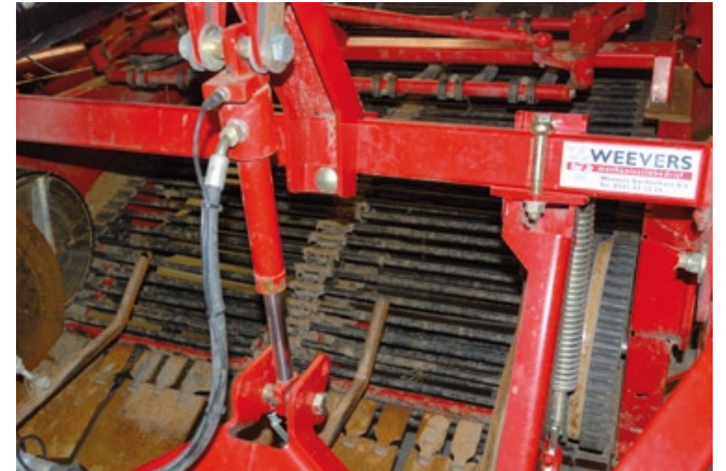
▲ Een aardappelrooier bevat diverse rooimatten met spijlen. Een verbogen spijl is vaak wel weer recht te buigen.
