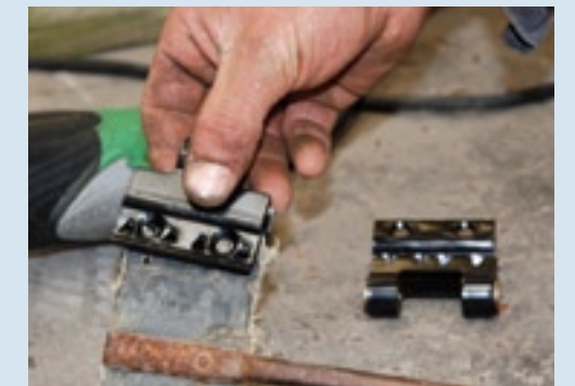
▲ Wanneer de band waarop de spijlen zitten geklonken op één plaats is beschadigd, kun je dit oplossen door een nieuwe sluitschakel te plaatsen. Deze sluitschakel wordt ook met behulp van klinknagels verbonden met de band van de rooimat. Het is van belang dat in de sluitschakel voldoende materiaal van de aandrijfband is opgesloten om afscheuring te voorkomen. Is de band op meerdere plaatsen beschadigd, dan kan hij door een gespecialiseerd bedrijf volledig worden vervangen waarbij de oude spijlen nog weer gebruikt worden.
