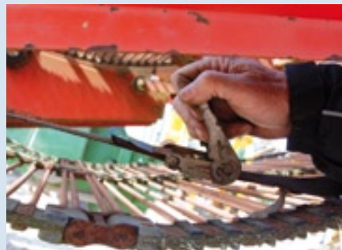
▲ Is een spijl van een rooimat beschadigd door een stuk hout of metaal, dan zal de rooimat in de meeste situaties van de aardappelrooier af moeten om hem te kunnen repareren. Dit begint met het losmaken van de sluitschakel. Daarvoor breng je aan beide kanten van de rooimat een spanband aan. Door deze spanbanden op spanning te brengen, gaat de spanning van de sluitschakel af en kan die makkelijker worden losgemaakt. De spanbanden moet je aan beide kanten van de rooimat aanbrengen om scheef-trekken te voorkomen.
