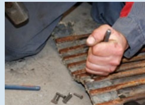
▲ Wanneer een deel van de klinknagel is weggeslepen, is deze vervolgens te verwijderen door met een doorslag de klinknagel er uit te tikken. Ondersteun hiervoor de spijl zoveel mogelijk door er een stuk metaal of hout onder te leggen. Mocht de klinknagel nog niet goed los willen, dan is het aan te bevelen om nog meer van de oude spijl weg te slijpen.
