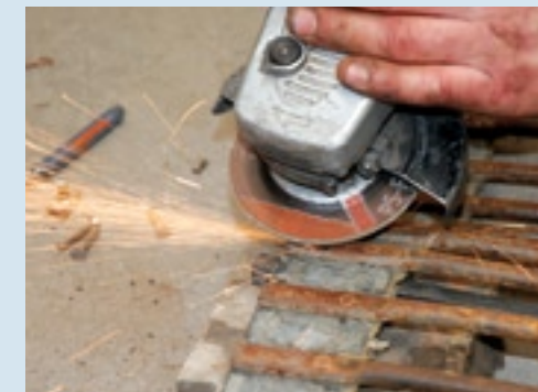
▲ Is de klinknagel goed uitgeklonken, dan kun je hem aan de bovenzijde nog glad slijpen. Dit voorkomt aanhaken van stukken stengel of beschadiging. Doordat het gat waarin de klinknagel zit ook aan de bovenzijde iets breder uitloopt, kan de klinknagel na het afslijpen niet meer los komen.
