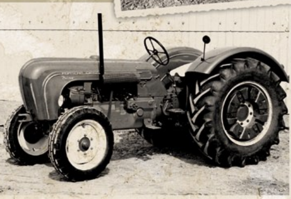
De Master van Porsche heeft een viercilindermotor met 50 pk, een 8+2 transmissie, een top van 20 km/h en weegt 2.100 kg.
